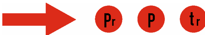
Rys.11. Znaki informacyjne kierunku przepływu oraz wyjść do pomiaru ciśnienia i temperatury.
